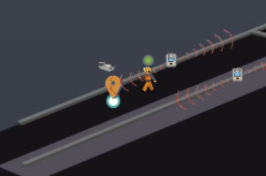
Система слежения за подземным персоналом и оборудованием
