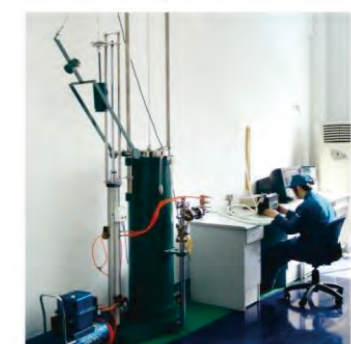
Стандартное устройство для контроля расхода газа с помощью колокола
