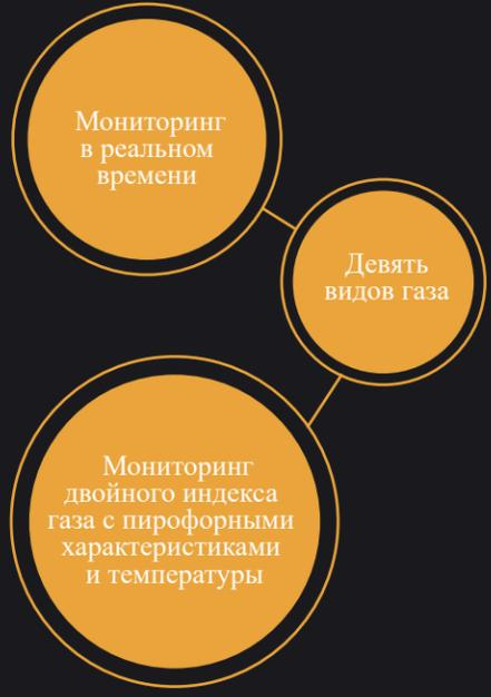
В режиме реального времени отслеживается концентрация девяти характерных газов самовозгорания угля, включая CH<sub>4</sub>, CO, O<sub>2</sub>, CO<sub>2</sub>, C<sub>2</sub>H<sub>2</sub>, C<sub>2</sub>H<sub>4</sub>, C<sub>2</sub>H<sub>6</sub>, H<sub>2</sub>, N<sub>2</sub>, а также температура в каждой точке мониторинга.
